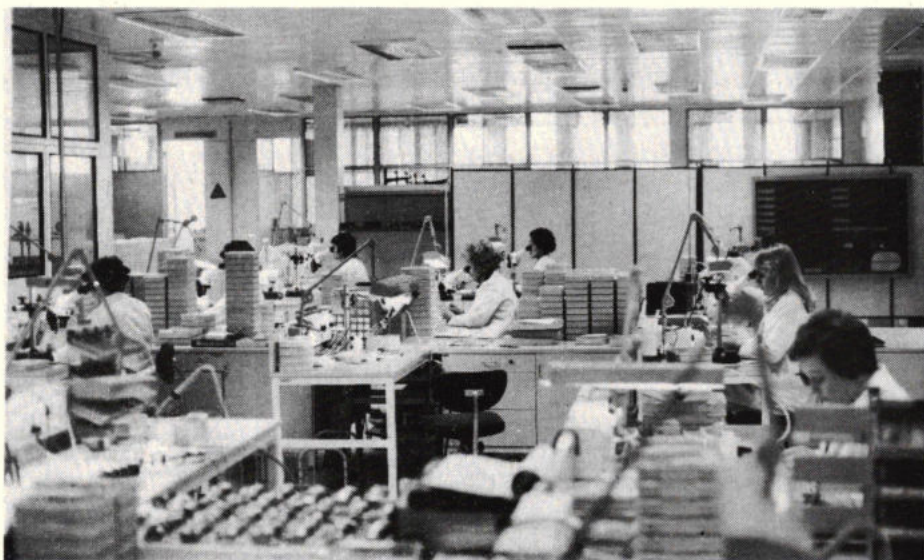
Afb. 4. Ieder afzonderlijk onderdeel van een pacemaker gaat door verschillende testcycli om functioneren en duurzaamheid te beproeven. Bij de geringste onvolkomenheid volgt onverbiddelijk afkeuring.
