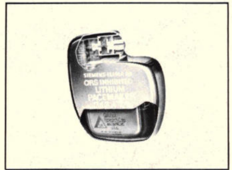
Afb. 9. Lithium-pacemaker 217/70: een hermetisch gesloten titanium huis met in epoxyhars gevatte elektronische componenten.
