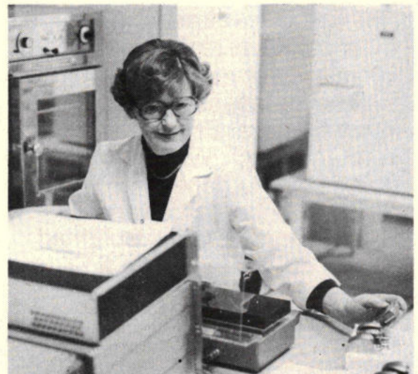
Afb. 8. Op dit meetstation wordt de pacemaker eerst op lichaamstemperatuur gebracht, om vervolgens nog eens alle parameters op hun nauwkeurigheid te beproeven.
